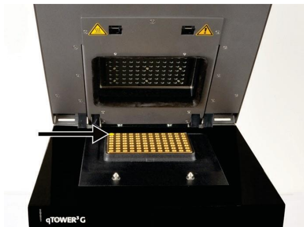
Fig. 10 Position A1 sur le thermobloc
